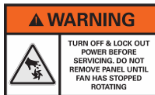
Verletzungsgefahr! Unterbrechen Sie die gesamte Stromversorgung des Kühlgeräts bevor Sie das Gehäuse öffnen.
